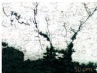
Primjer korozije uslijed transkristalne napukline zbog naprezanja na nehrđajućem čeliku 1.4401 u slučaju visoke koncentracije klora.
